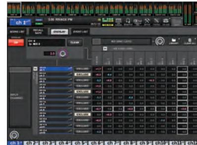
Overlay Filter 可以显著拓展调音台场景记忆功能的实用性。它可以实现独立于场景调用的“Overlaid”覆盖功能，允许在当前混音状态下，临时性调整推子偏移量和混音 / 矩阵母线发送量而不受场景调用影响。例如当演出发生计划外的状况时，覆盖过滤器可以帮助工程师对该通道做出临时性的改变，随后即可迅速恢复到原有的参数设置。Overlay Filter 功能在需要临时性调整以及迅速恢复原有设置的情况下，有巨大的价值。
