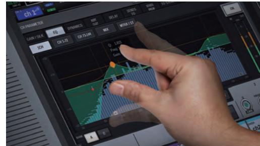
这款高可视性 15 英寸显示屏以易于理解的布局将必备的控制和信息融为一体，工程师能够快速高效地读取和应对各种情况。触控灵敏度不仅支持基本的点击和选择，还可使用熟悉的捏合和滑动手势，显著提升操作效率。显示屏与广为熟知的雅马哈选定通道部分联动，提供紧凑的必备物理控制，实现快速、直观的动手操作。
