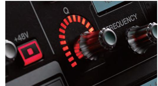
我们在设计上做出了巨大努力，确保提供给工程师的操作反馈始终清晰如一，以便他们做出合适的混音决策。通道条顶部多功能编码器周围环绕的“马蹄环型”指示灯也经过精心设计，站在工程师的视角，每个段落都完全可见。尤其是在现场混音的情况下，每一处细节都很重要。
