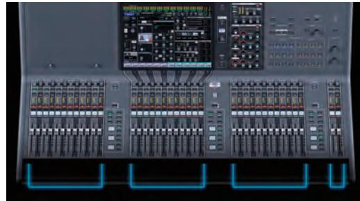
RIVAGE PM3 可能是 RIVAGE PM 系列中最紧凑的型号，但它仍具备 38 个 (12+12+12+2) 物理推子。RIVAGE PM 系列均采用此类配置，带来直观的实际操作混音，同时使得工程师能够轻松上手任意一款 RIVAGE PM 系列型号而不会迷失方向。
