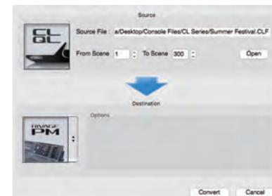
Yamaha Console File Converter（雅马哈调音台文件转换器）是一款非常实用的应用软件。用户可以实现 RIVAGE PM 系列、CL/QL 系列、PM5D、M7CL 和 LS9 调音台之间的数据共享，即使使用完全不同的调音台，一台设备中的参数数据也无需彻底重新编程就能复制到另外一台上并使用。
