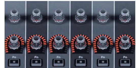
RIVAGE PM10 和 PM7 控制界面为每个通道配备两个编码器：可分配给五个不同功能的通道条编码器，以及控制相邻显示面板上相应参数的屏幕编码器。当涉及到实际操控时，物理控制器实力拔群，因此每个通道上的两个编码器的可用性为 PM10 和 PM7 增添了操作上的优势。
